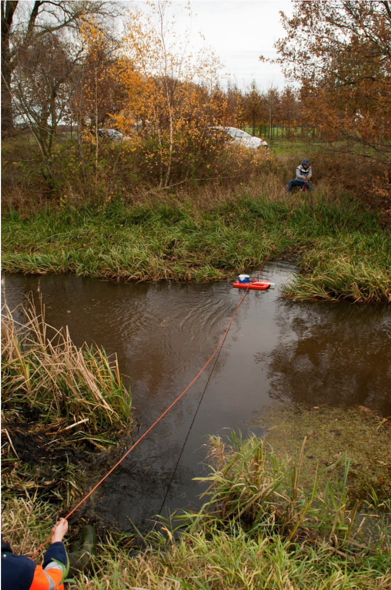
Figuur 0.6 Site #3, profiel 1, voorbeeld van het uitzetten van een traject voor de StreamPro.
