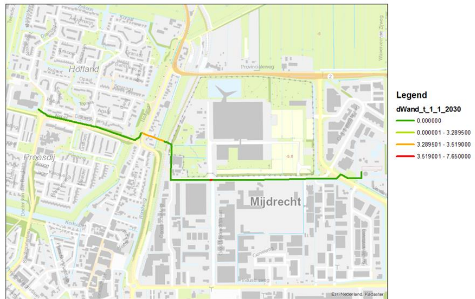
Figuur 6.28: Berekende aantasting op 1 jan 2030 voor de leiding Ducaton; eenheid [mm]
