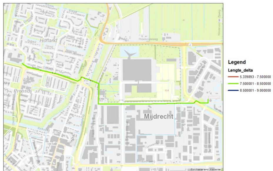
Figuur 6.26: Berekende lengte "delta" voor persleiding Ducaton; eenheid [m]
