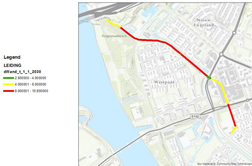
Figuur 6.11: berekende aantasting op 1 jan 2030; eenheid [mm]
