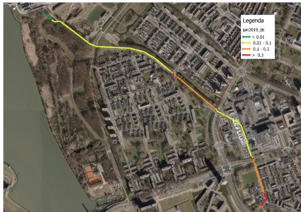
Figuur 6.9: Totale zettingsverschillen uit het deelmodel zettingen voor het gemodelleerde deel van persleiding Holwinde op 1 januari 2019; eenheid [m]
