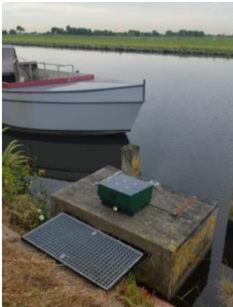
Figuur 4.1 Geautomatiseerde inlaatsturing op basis van saliniteitsmetingen (Delsman et al., 2016)
