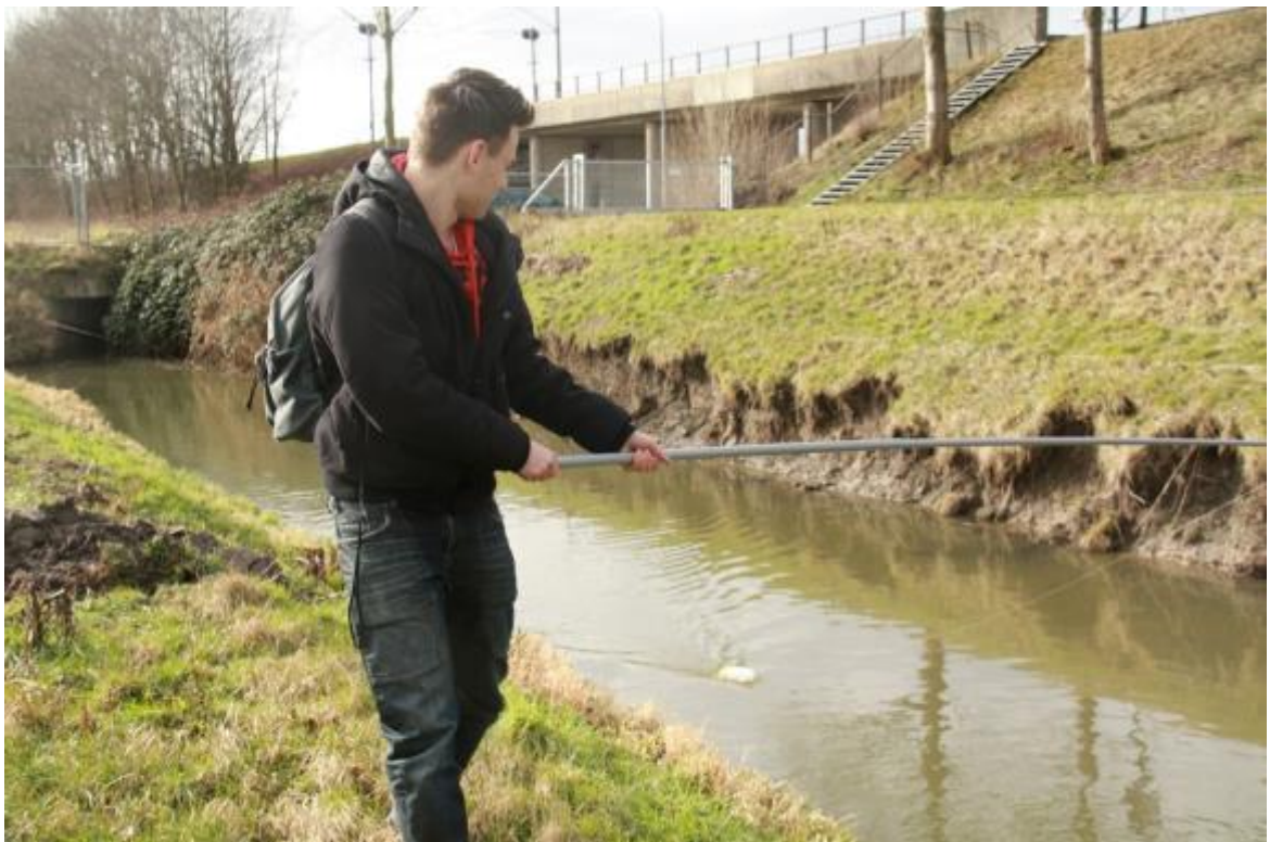
Figuur A.1 Uitvoeren van een EC routing met behulp van een EC sensor aan een drijver, voortgetrokken met een hengel.
