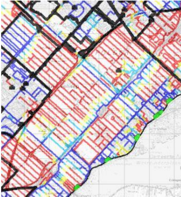
Figuur A.5 Voorbeeld resultaat berekening fractie inlaatwater (blauw=hoge fractie inlaatwater, rood = lage fractie inlaatwater)
