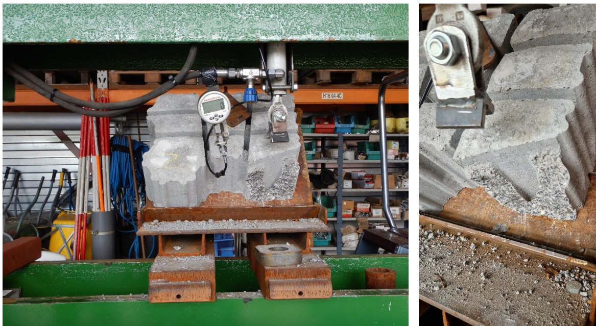
Foto 11 en 12: Breukvlak D5d1 door brug
