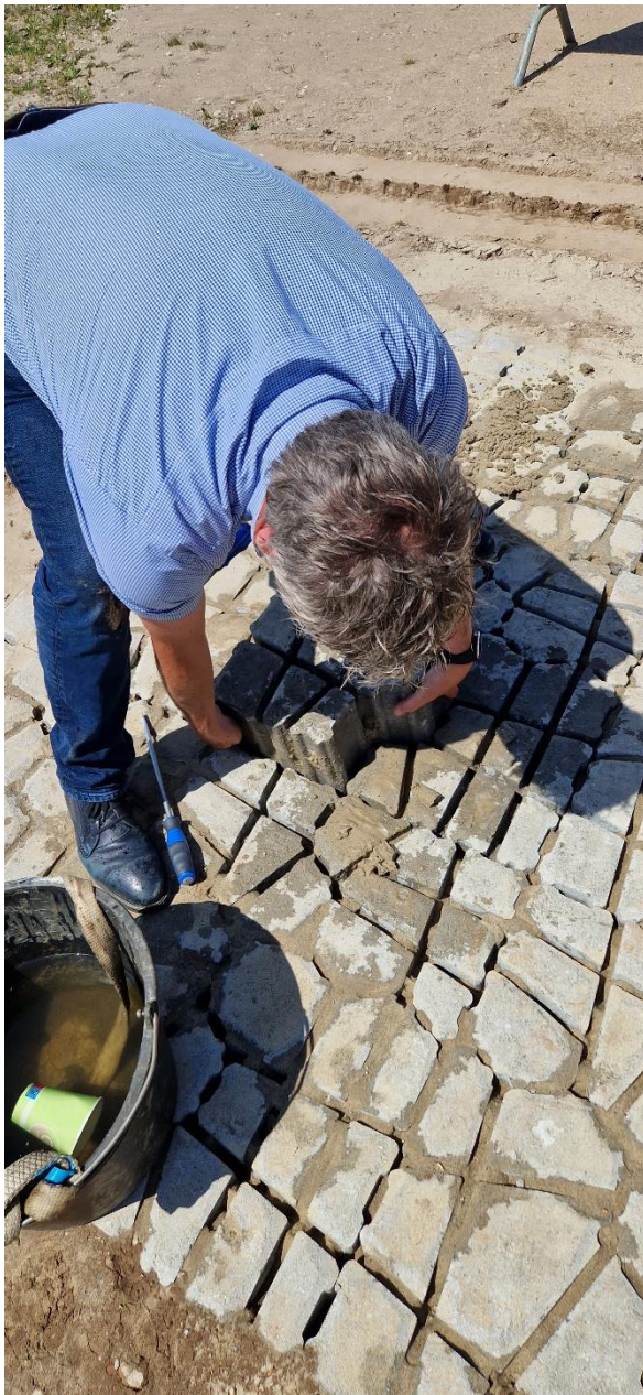
Foto 31 en 32: Grootste steen na de proeven uit de verharding.
