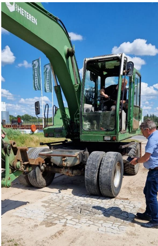
Figuur 25 en 26: Mobiele kraan bij proefvak en achterwiel op zetsteen.
