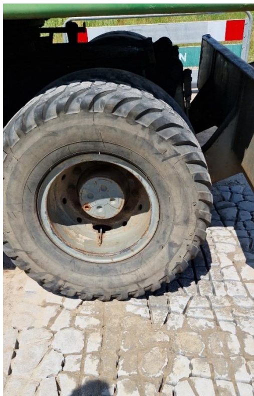
Figuur 25 en 26: Mobiele kraan bij proefvak en achterwiel op zetsteen.
