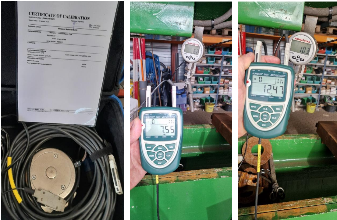
Figuren 7, 8 en 9: Kalibratieapparaat en 2 kalibratiemetingen.
