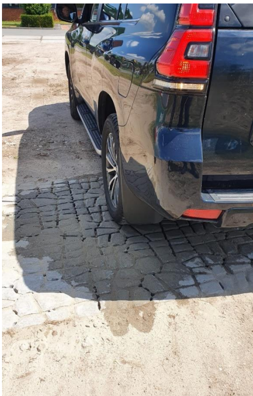
Figuur 21 en 22: Wiellast 760kg op proefvak
