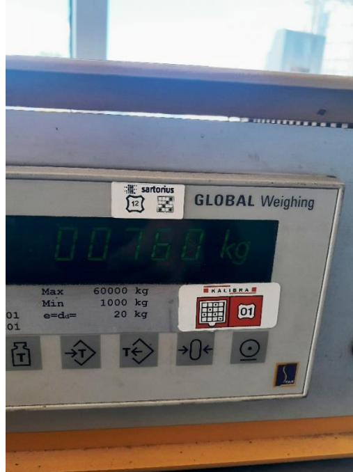
Figuur 19 en 20: Voertuig met 1 wiel op weegbrug en uitlezing gewicht.
