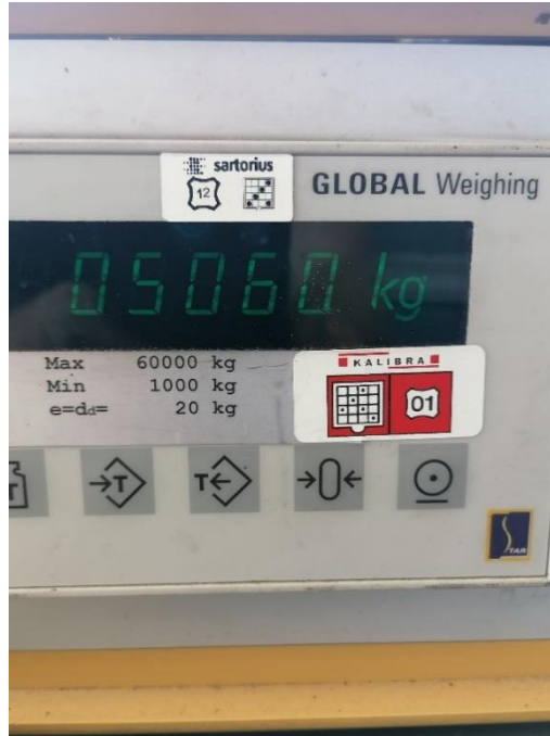
Figuur 23 en 24: Mobiele kraan met 1 askant op weegbrug en uitlezing gewicht
