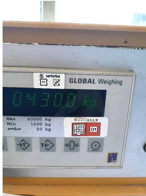
Figuur 27 en 28: Heftruck met 1 askant op weegbrug en uitlezing gewicht
