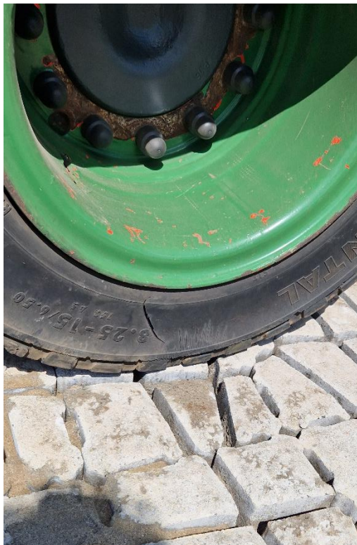
Figuur 29 en 30: Heftruck bij proefvak en voorwiel op zetsteen.
