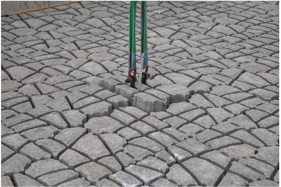
Fig. C-21, Vervorming bij proef 3.6 (68 mm verplaatsing)
