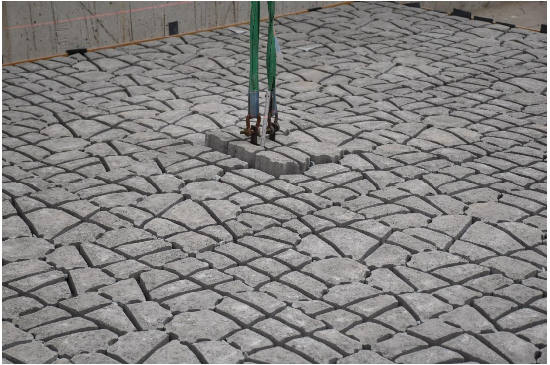
Fig. C-25, Vervorming bij proef 4.5 (58 mm verplaatsing)
