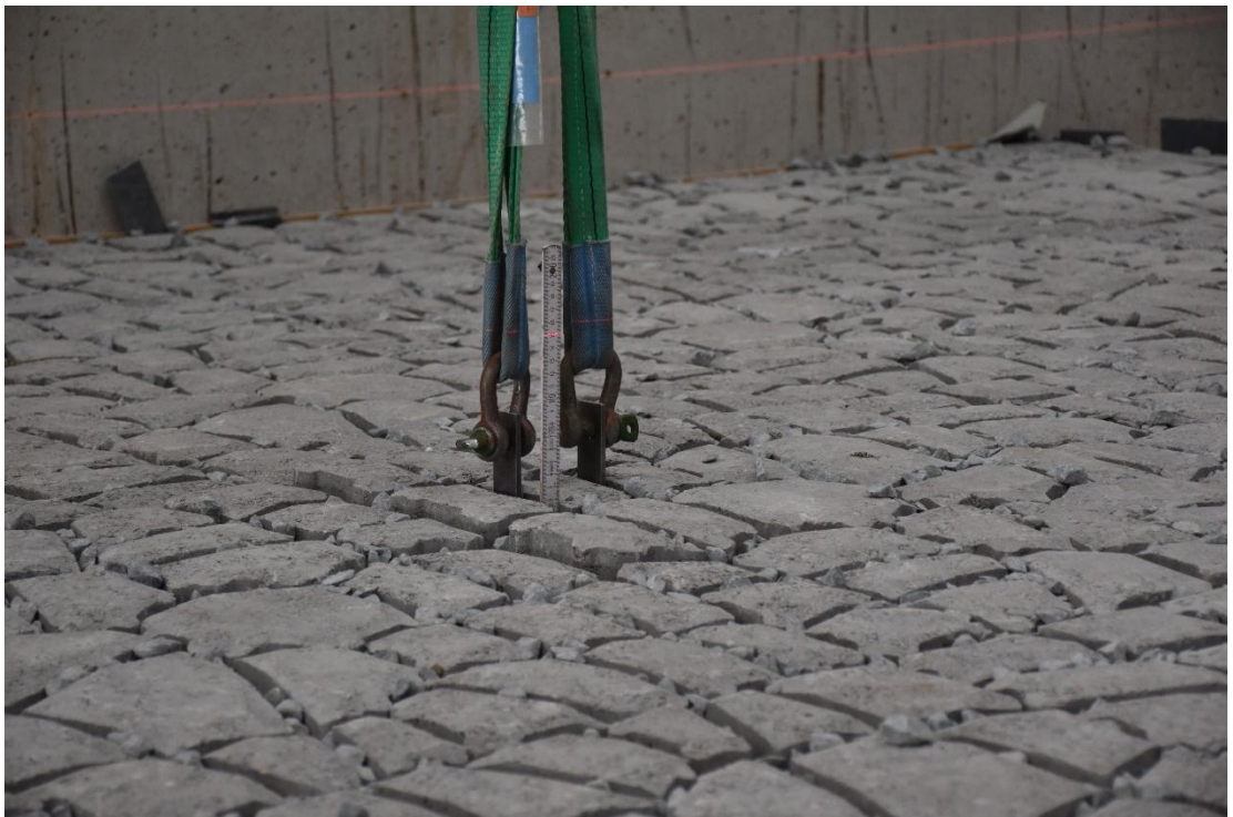
Fig. C-28, Vervorming bij proef 5.3 (30 mm verplaatsing)
