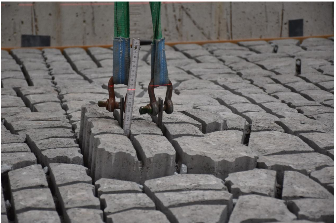
Fig. C-26, Vervorming bij proef 4.6 (75 mm verplaatsing)
