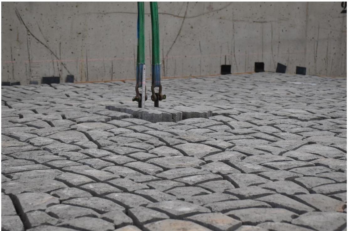
Fig. C-14, Vervorming bij proef 2.5 (50 mm verplaatsing)
