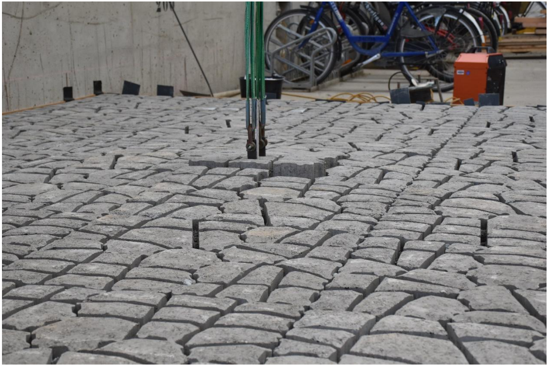
Fig. C-15, Vervorming bij proef 2.6 (60 mm verplaatsing)
