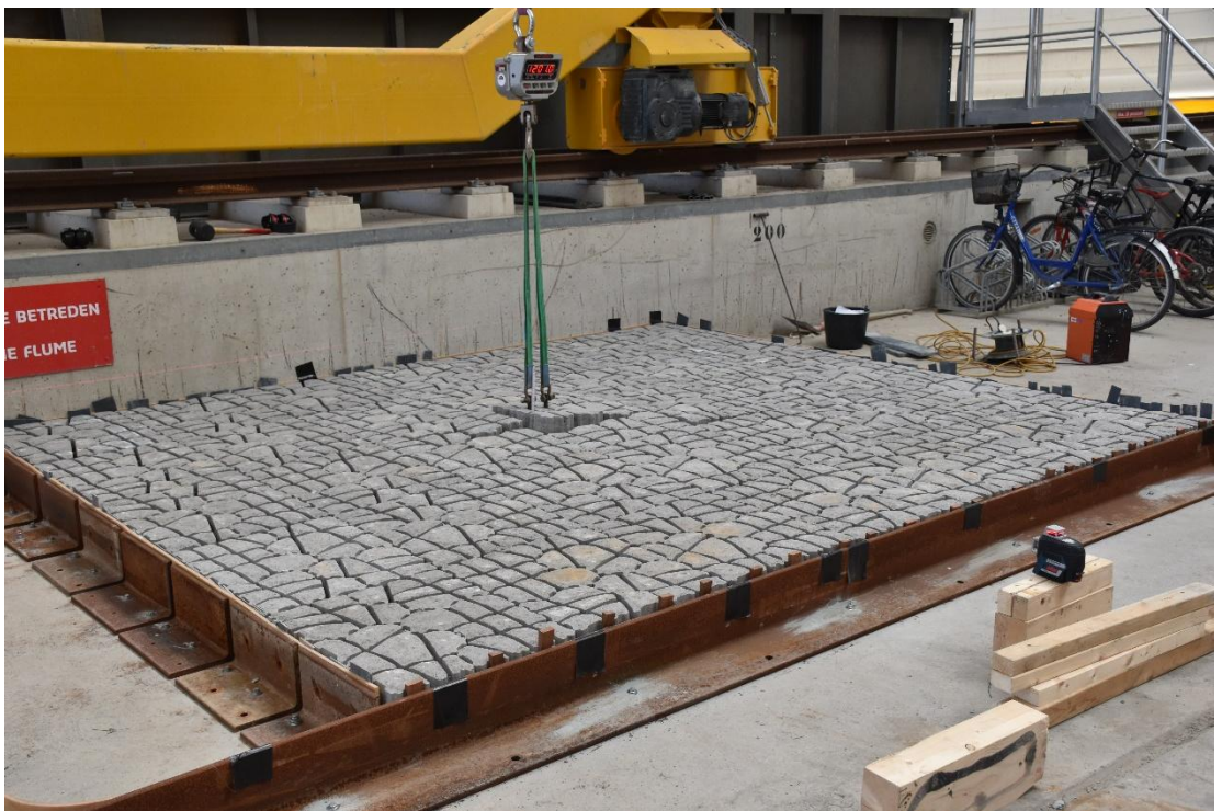
Fig. C-16, Vervorming bij proef 2.7 (86 mm verplaatsing)
