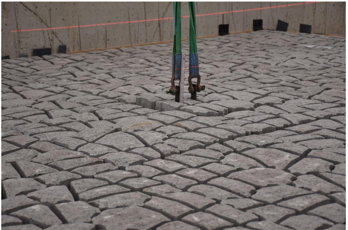
Fig. C-8, Vervorming bij proef 1.3 (30 mm verplaatsing)
