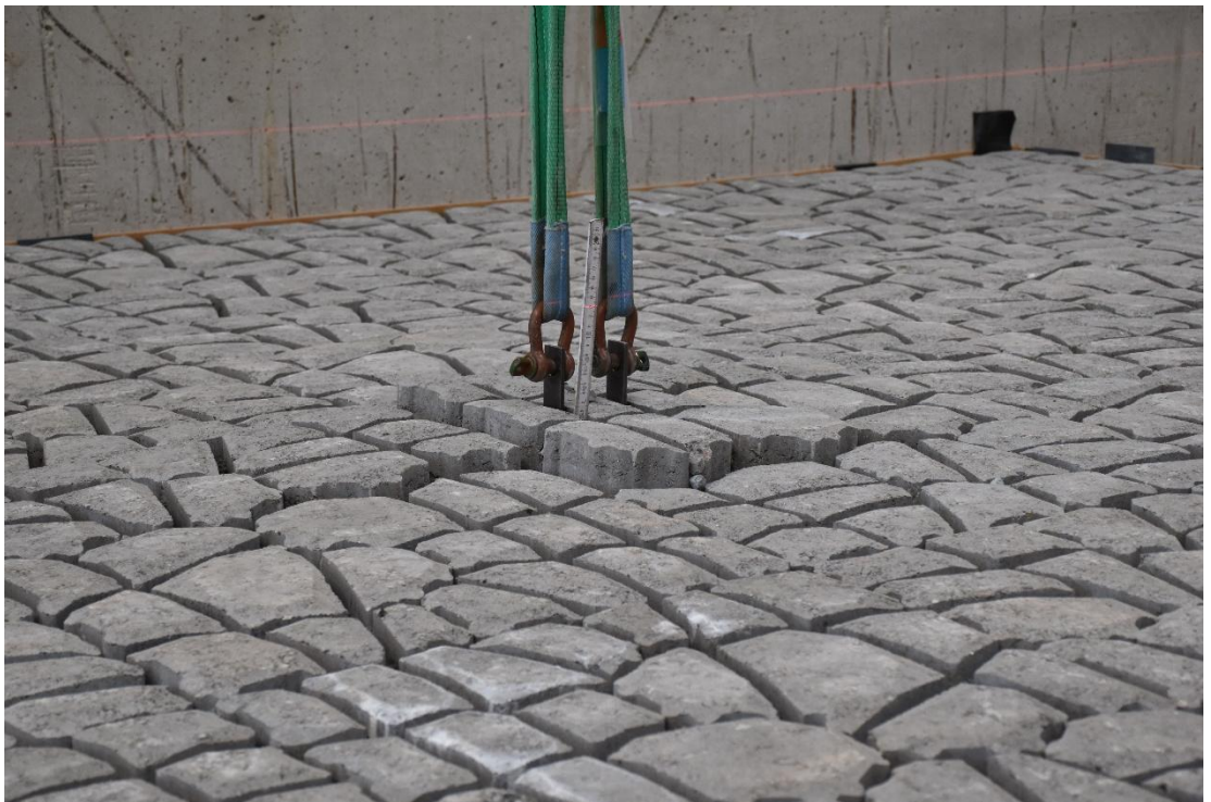
Fig. C-20, Vervorming bij proef 3.5 (50 mm verplaatsing)
