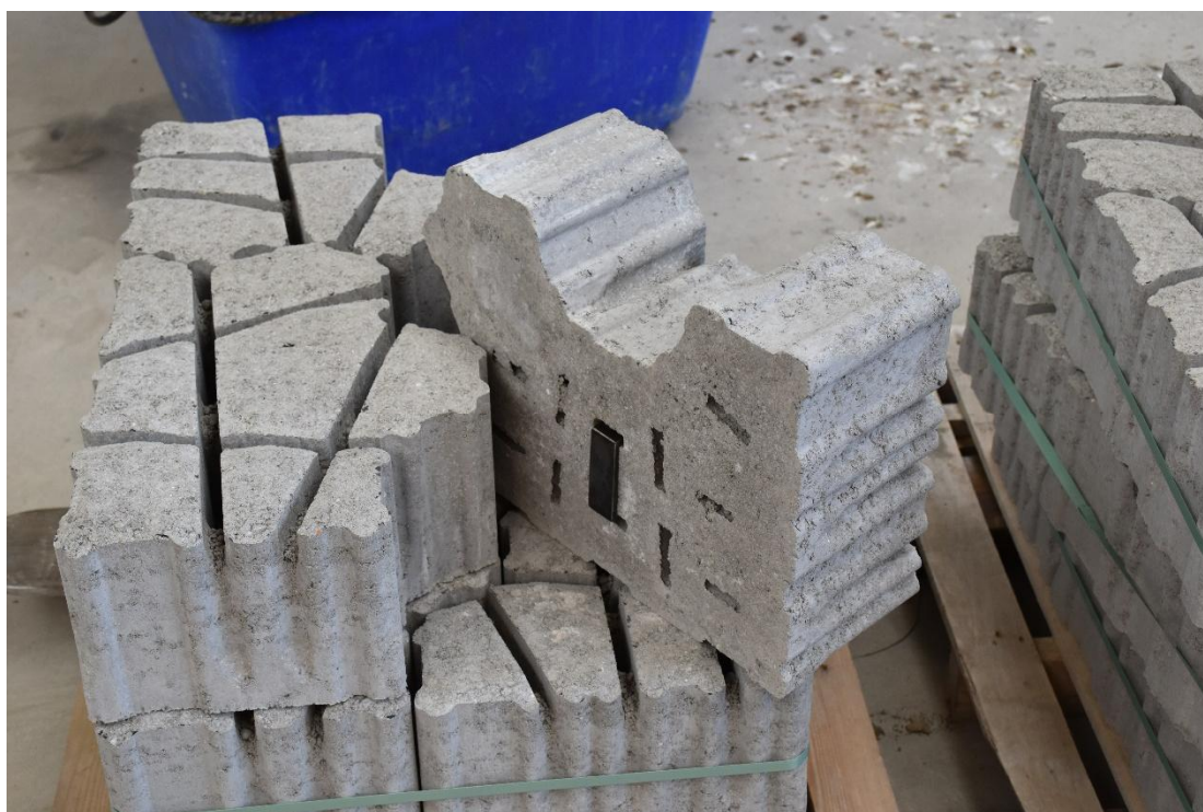
Fig. C-2, Zetsteen waaraan getrokken is door middel van een stalen beugel
