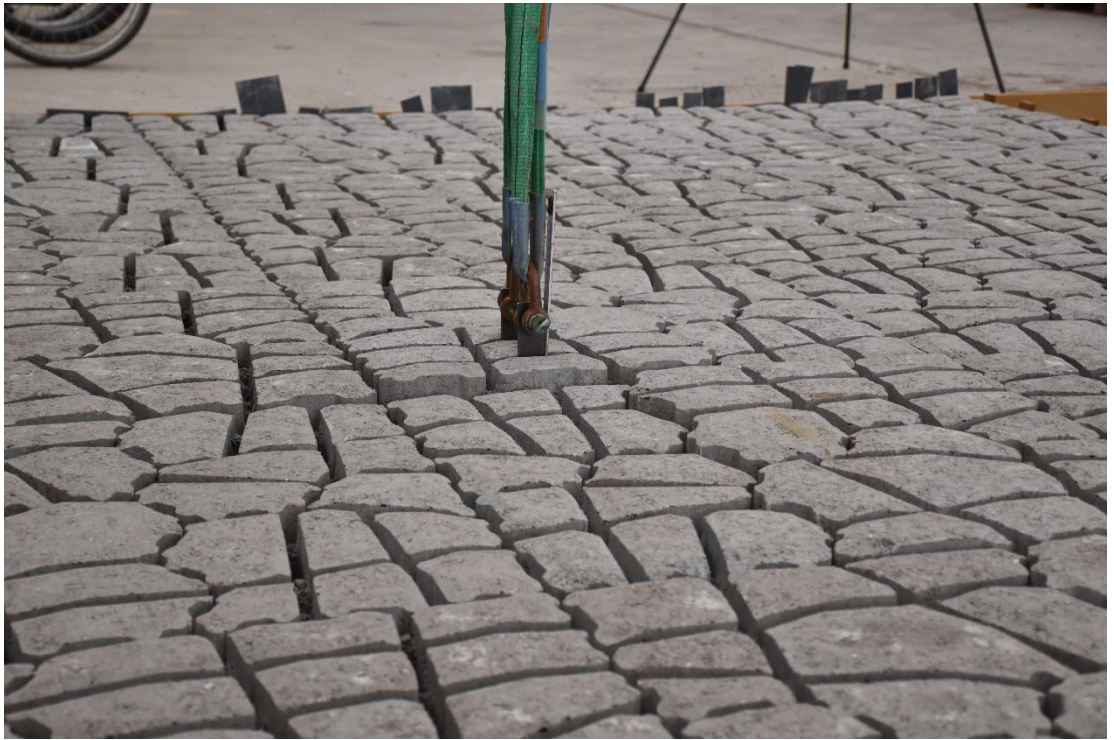
Fig. C-7, Vervorming bij proef 1.2 (19 mm verplaatsing)
