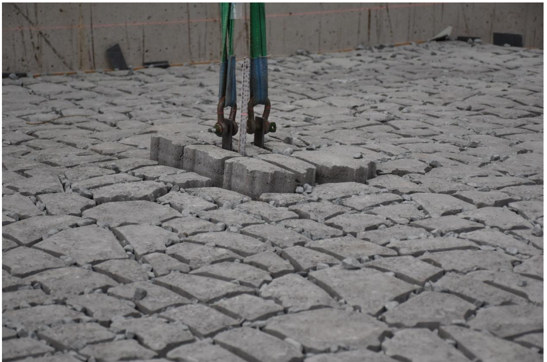
Fig. C-32, Vervorming bij proef 5.6 (79 mm verplaatsing)
