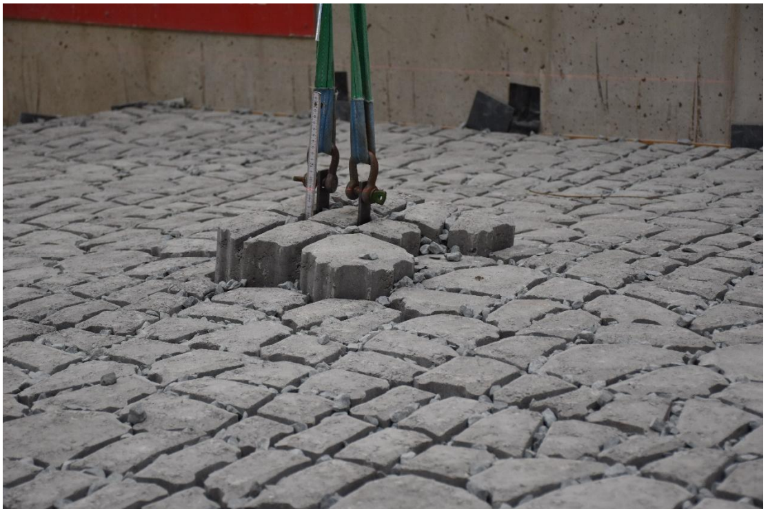
Fig. C-34, Vervorming bij proef 5.8 (118 mm verplaatsing)
