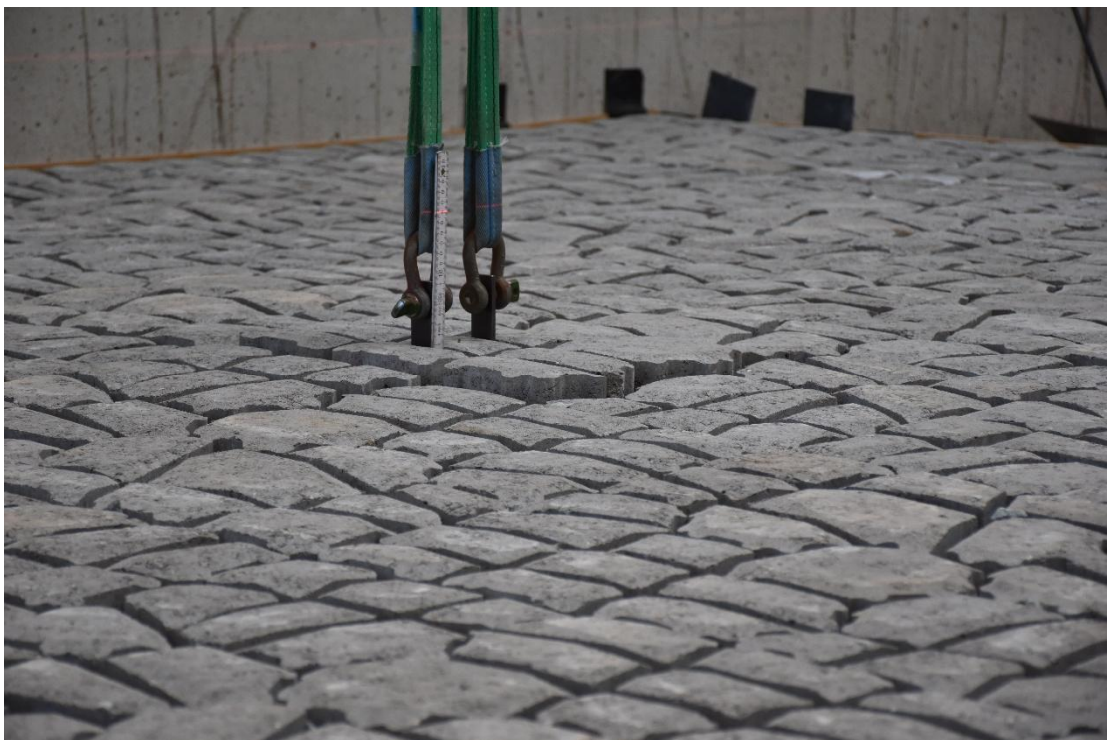
Fig. C-12, Vervorming bij proef 2.3 (30 mm verplaatsing)
