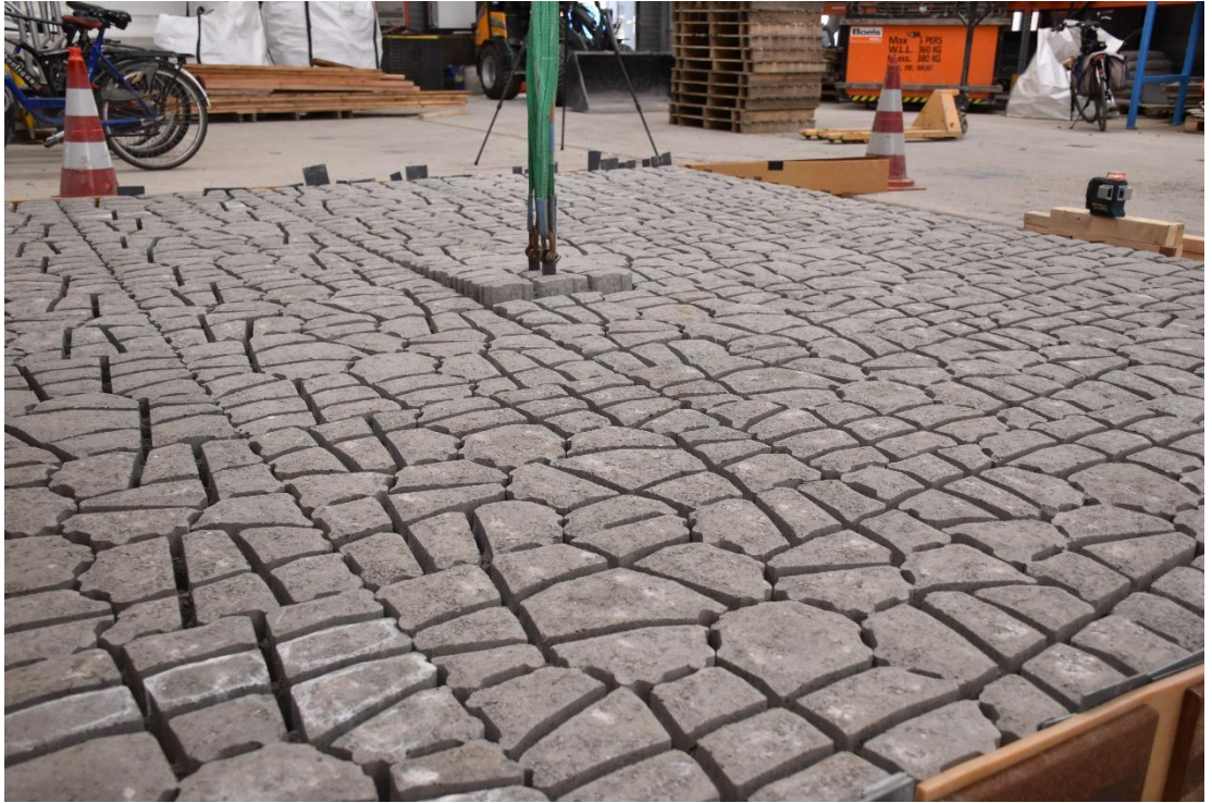
Fig. C-9, Vervorming bij proef 1.4 (42 mm verplaatsing)
