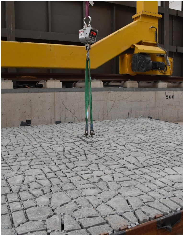
Fig. C-30, Vervorming bij proef 5.5 (50 mm verplaatsing)
