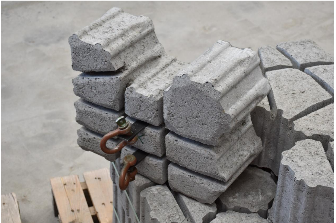
Fig. C-3, Zetsteen waaraan getrokken is door middel van een stalen beugel
