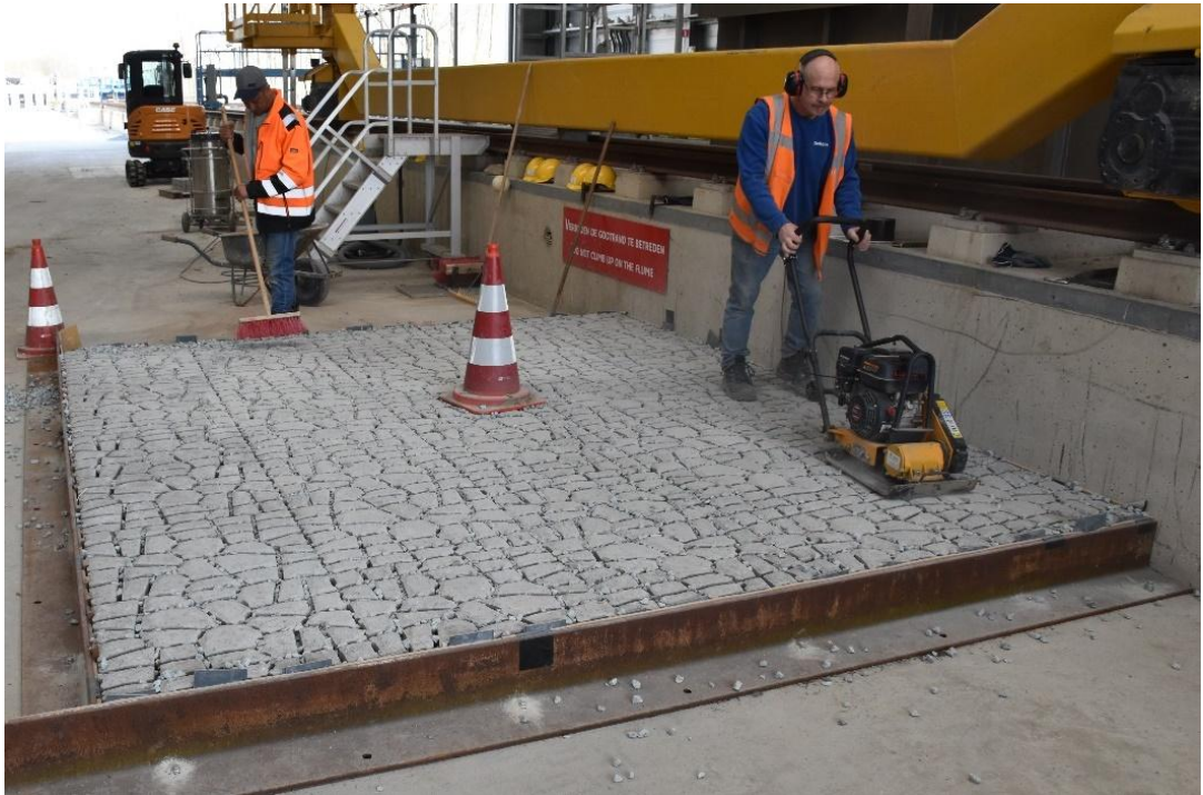
Fig. C-27, Volledig ingewassen steenzetting voor proef 5
