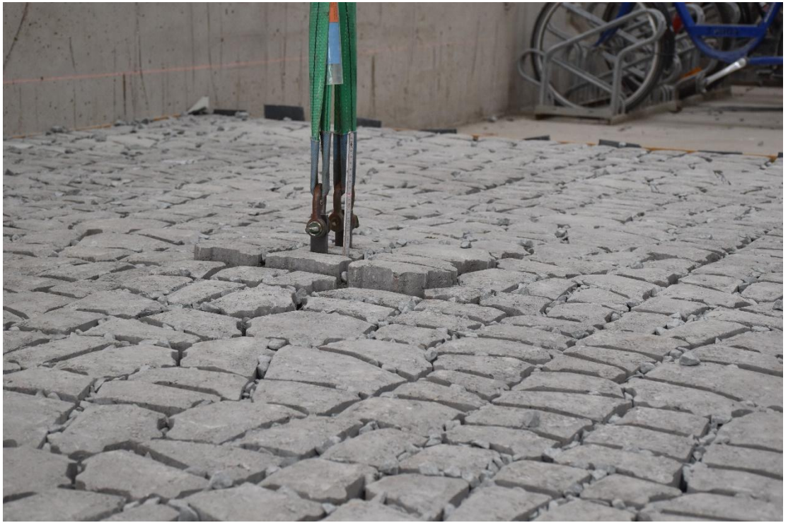
Fig. C-31, Vervorming bij proef 5.5 (62 mm verplaatsing)
