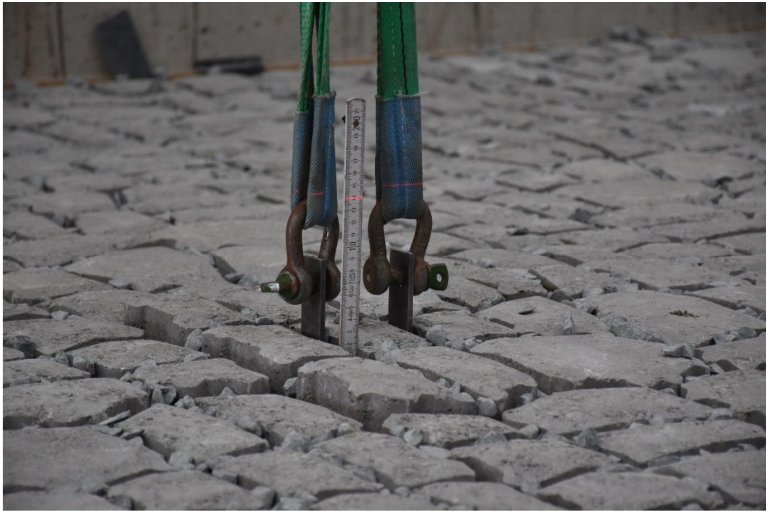
Fig. C-29, Vervorming bij proef 5.4 (40 mm verplaatsing)
