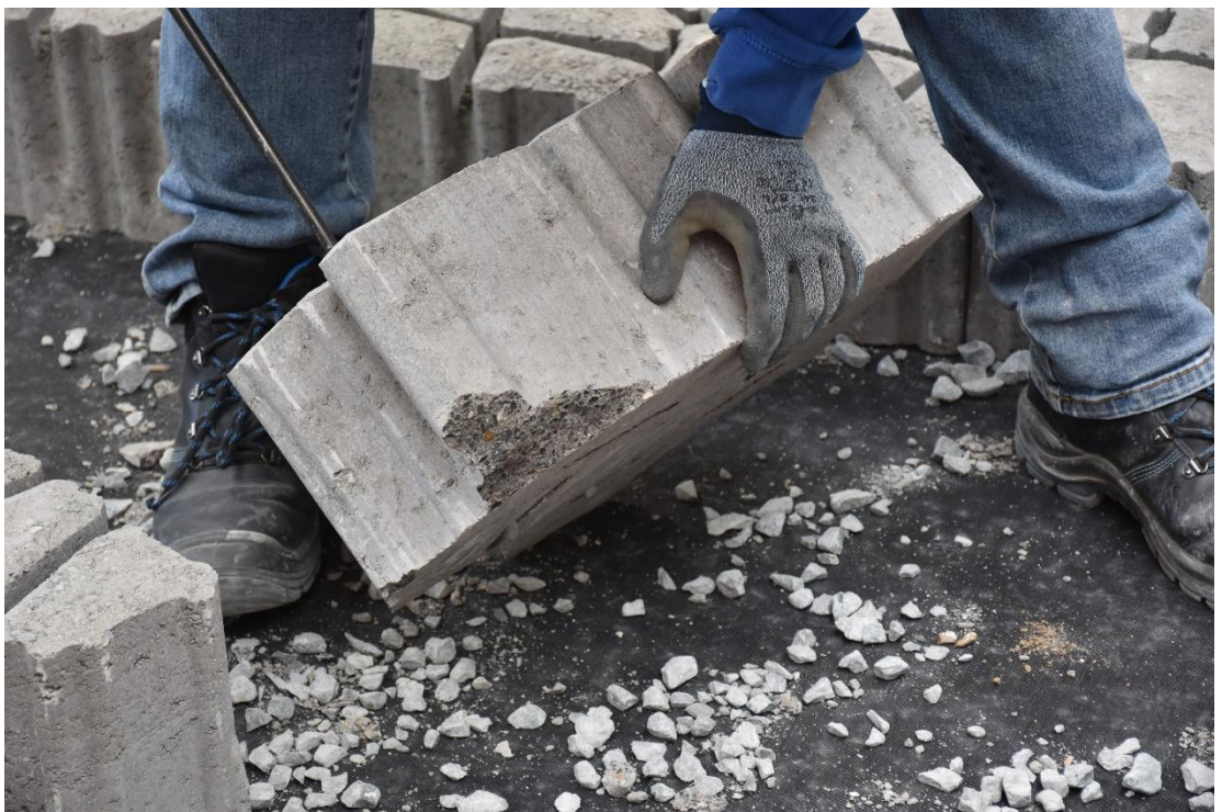
Fig. C-22, Schade aan zetsteen tijdens proef 3 (alle beschadigde zetstenen zijn steeds na elke proef vervangen)
