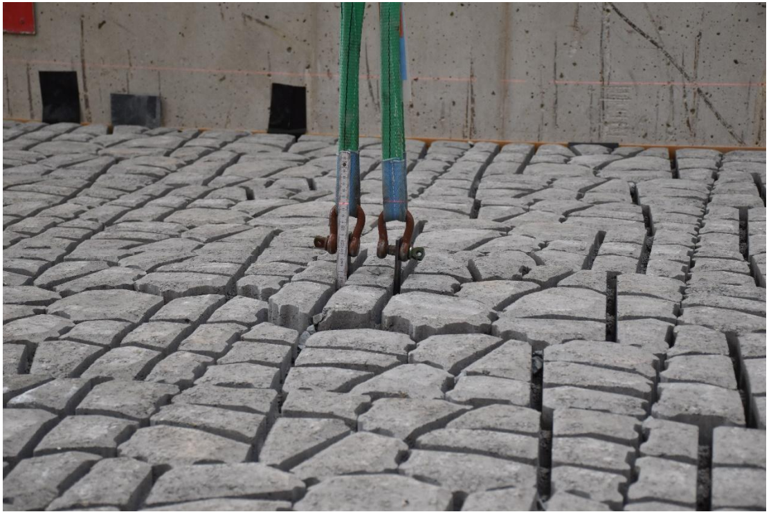
Fig. C-19, Vervorming bij proef 3.4 (40 mm verplaatsing)
