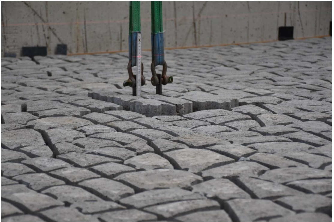
Fig. C-13, Vervorming bij proef 2.4 (41 mm verplaatsing)
