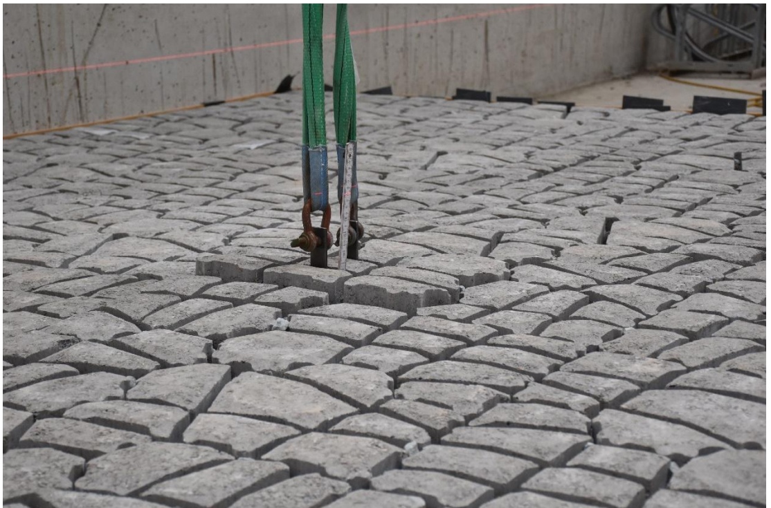
Fig. C-24, Vervorming bij proef 4.4 (46 mm verplaatsing)
