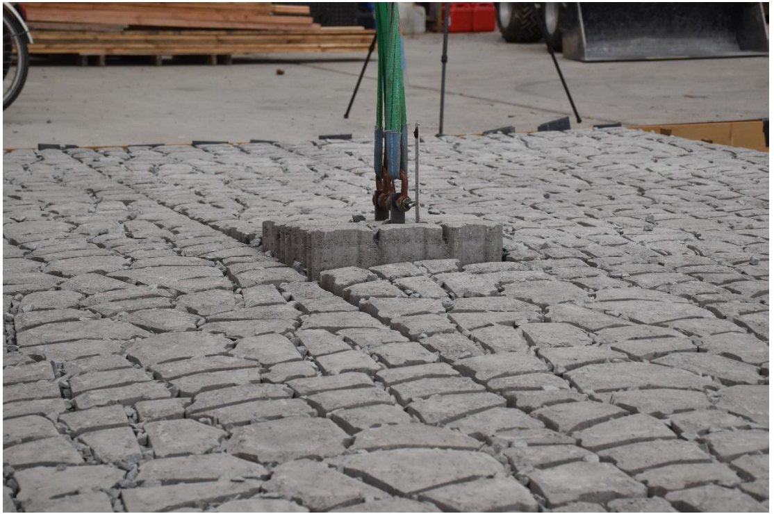
Fig. C-33, Vervorming bij proef 5.7 (102 mm verplaatsing)
