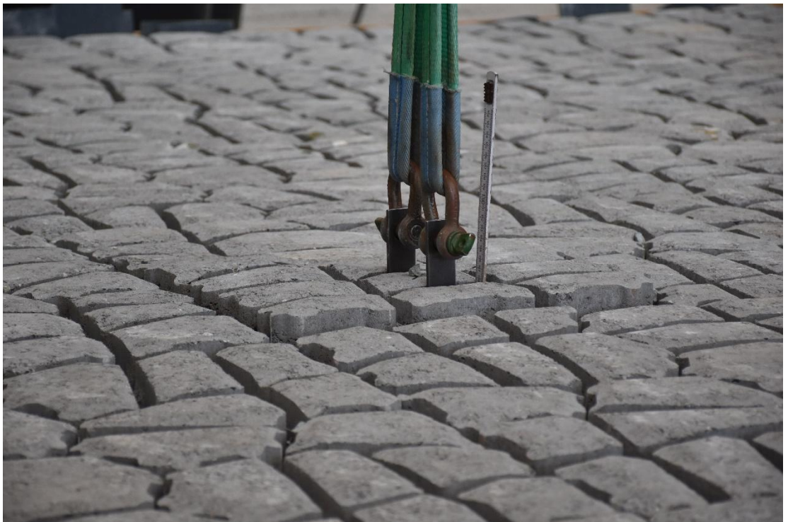
Fig. C-18, Vervorming bij proef 3.3 (30 mm verplaatsing)
