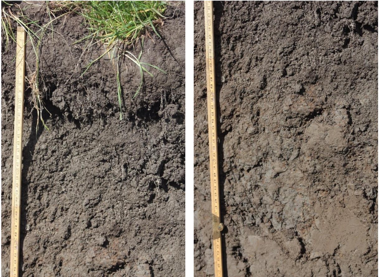
Figuur 2-2 Detailopnames van profielkuil 1. Links: de zodelaag tot circa 0.10 m -mv. Daaronder de laag met een fijne losse structuur die tot circa 0.35/0.40 m -mv doorloopt. Rechts: de overgang van de zone met een losse fijne structuur naar een open tot dichte grove structuur. De overgang begint hier rond 0.35 m -mv.
