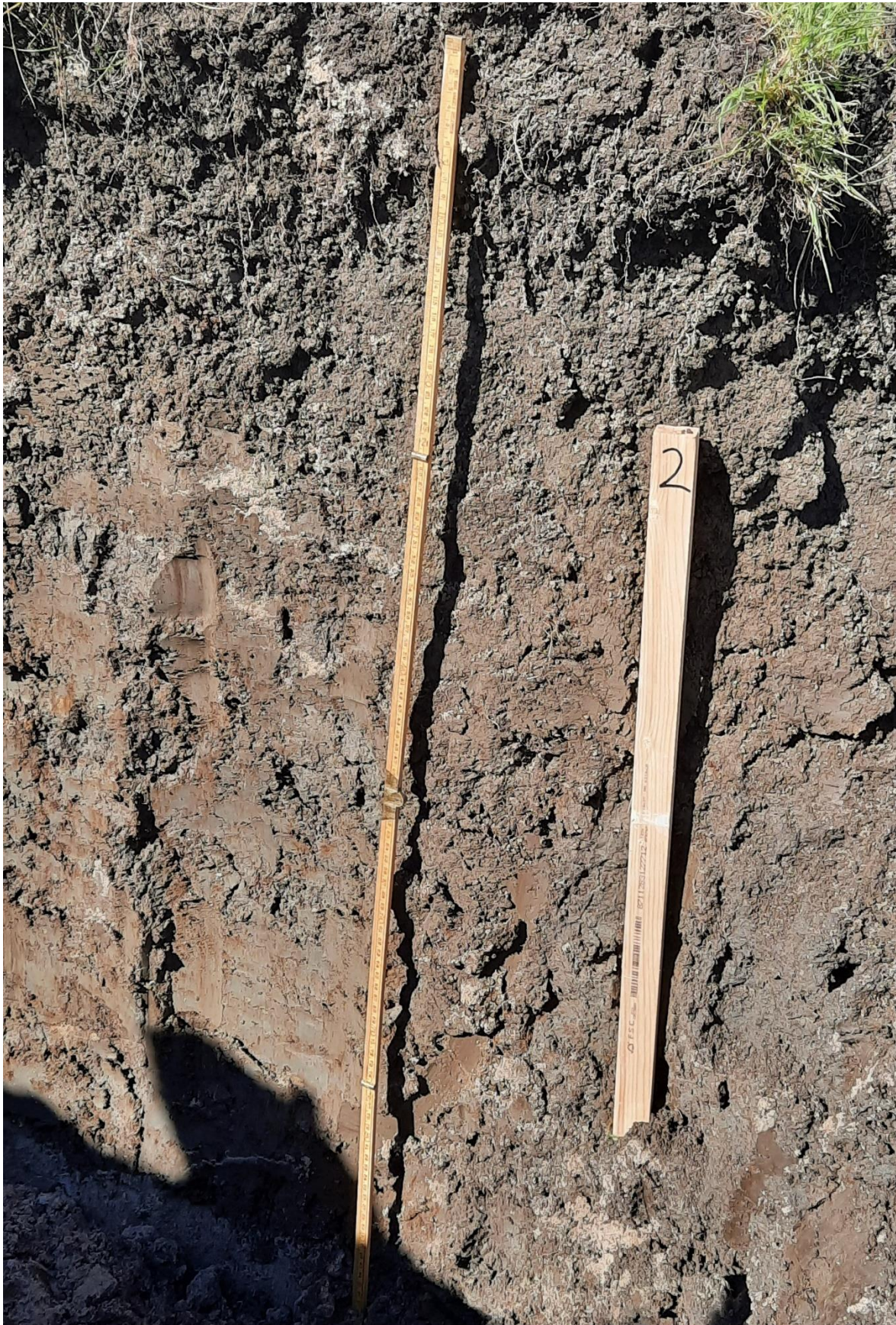
Figuur 2-3 Profielkuil 2. De duimstok is 1 m lang. De zodelaag boven is goed zichtbaar, met daaronder de fijne losse structuur tot circa 0.30/0.35 m -mv. Daaronder wordt de structuur grover en steeds dichter. Het dijkzand is zichtbaar in de schaduw links onderin.
