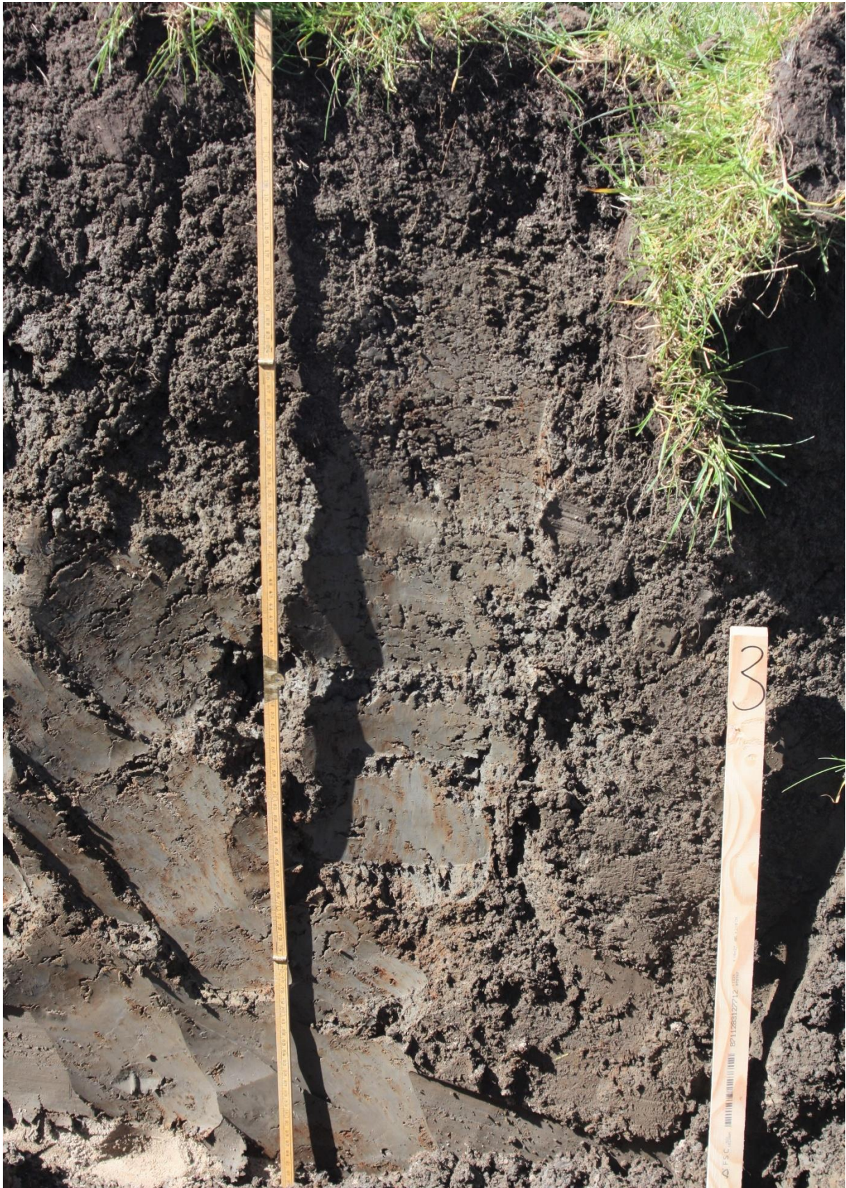
Figuur 2-4 Profielkuil 3. De duimstok is 1 m lang. De zodelaag boven is goed zichtbaar, met daaronder de fijne losse structuur tot circa 0.25 m -mv. Daaronder wordt de structuur grover en steeds dichter. Het dijkzand is zichtbaar links onderin.
