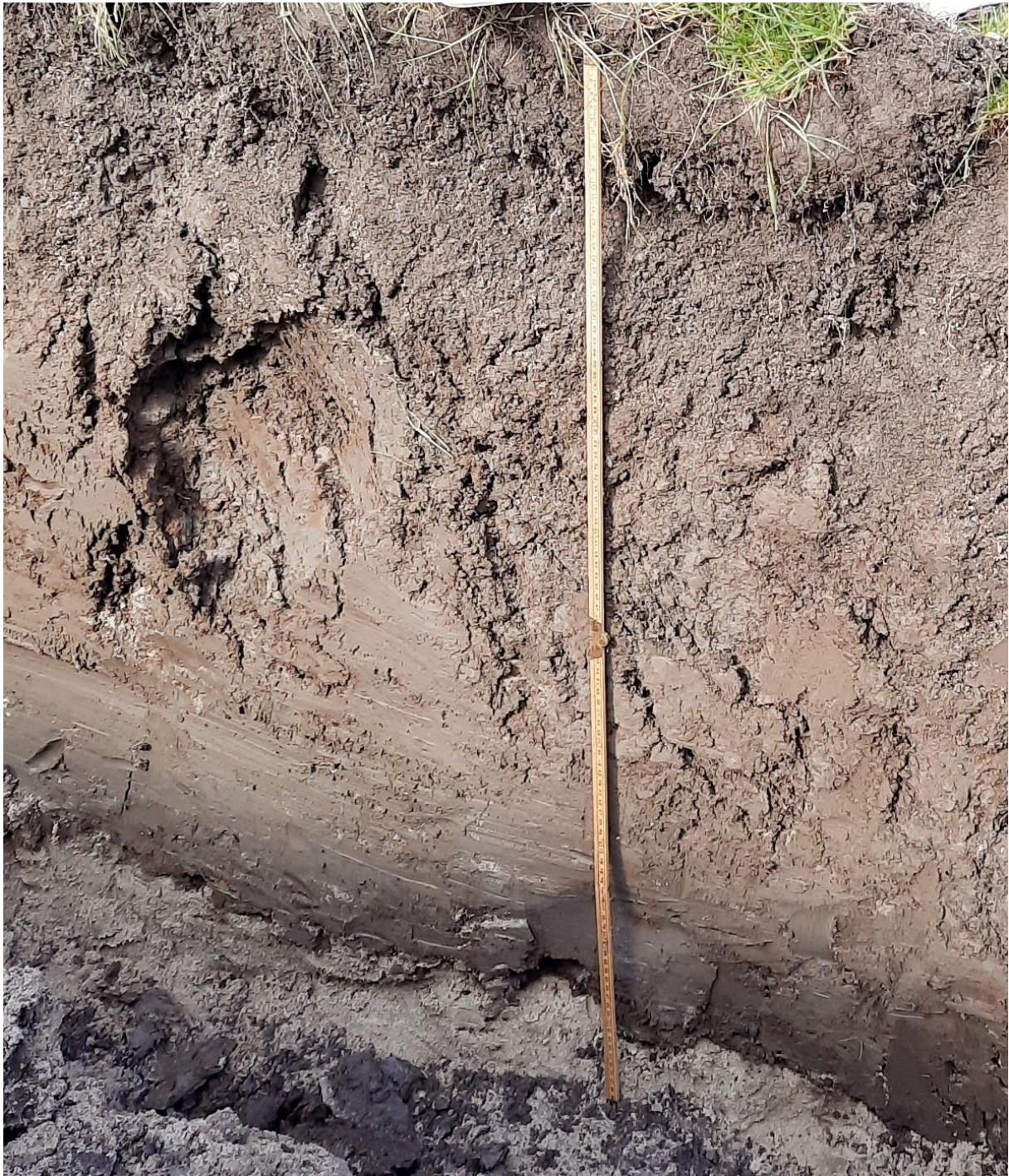
Figuur 2-1 Profielkuil 1. De duimstok is 1 m lang. De zodelaag boven is goed zichtbaar, met daaronder de fijne losse structuur tot circa 0.35/0.40 m -mv. Daaronder wordt de structuur grover en steeds dichter. Direct boven het dijkzand is de klei vrijwel massief.
