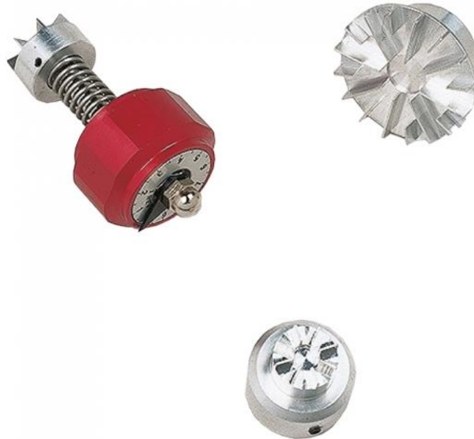
Figuur 1.2 Hand torvane, in veld is CL-100 gebruikt, hier zit deze vast aan het handvat.
