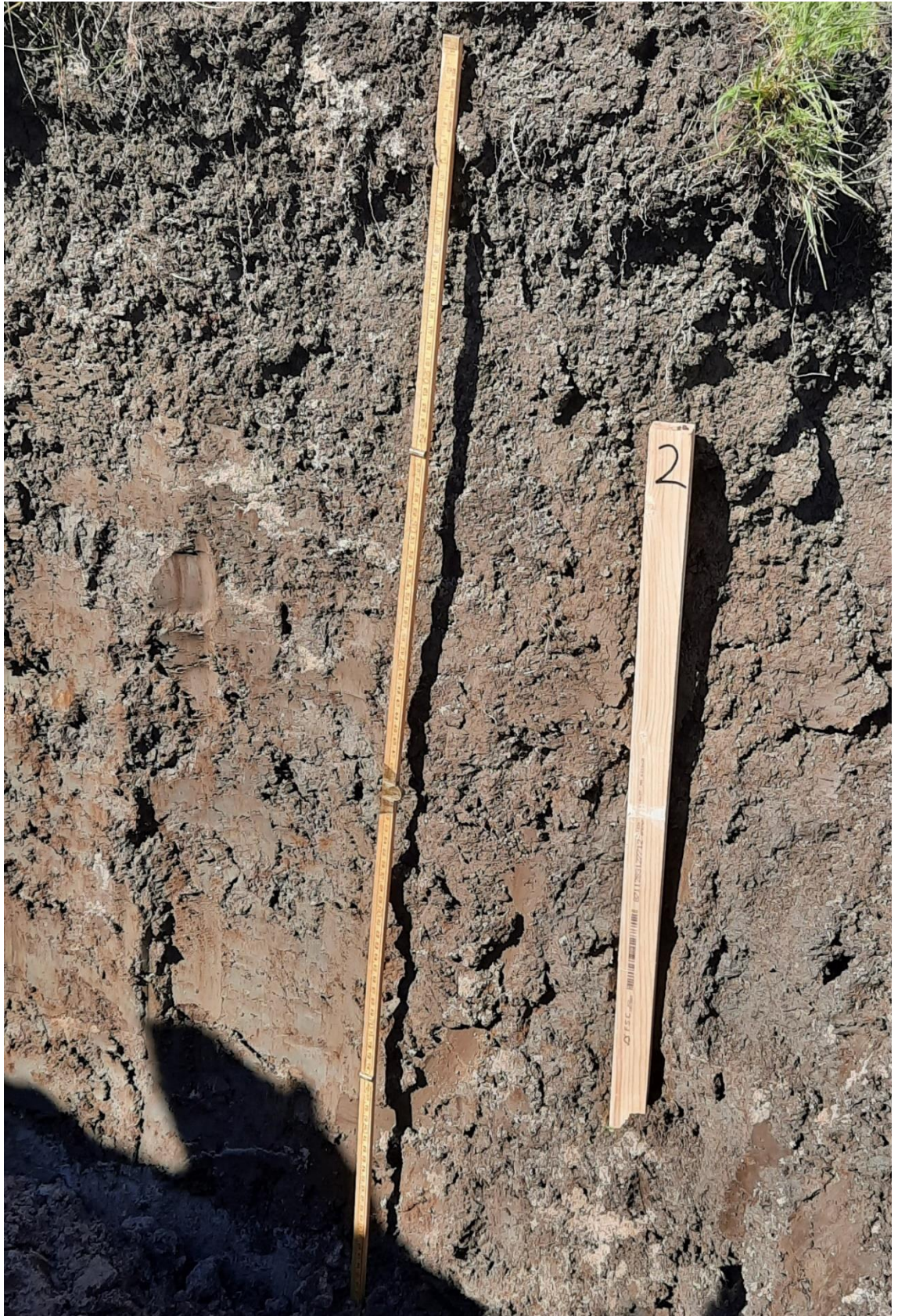
Figuur 2.5 Profielkuil 2. De duimstok is 1 m lang. De zodelaag boven is goed zichtbaar, met daaronder de fijne losse structuur tot circa 0.30/0.35 m -mv. Daaronder wordt de structuur grover en steeds dichter. Het dijkzand is zichtbaar in de schaduw links onderin.
