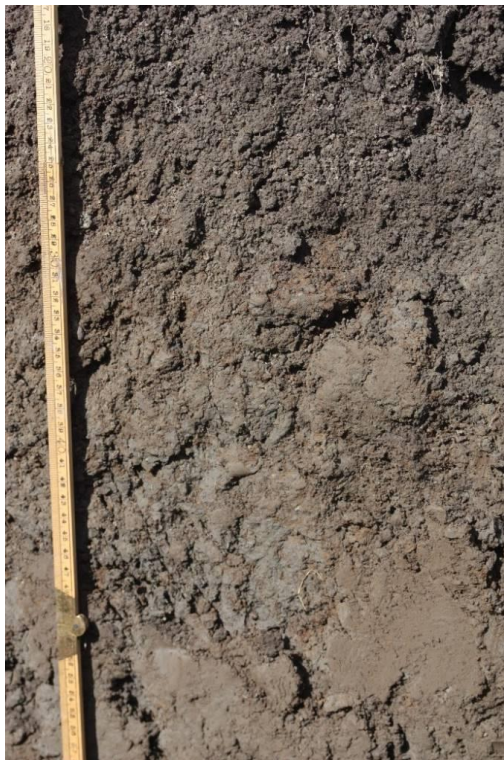
Figuur 2. Bovenin: losse structuur; daaronder een overgang naar een steeds dichtere structuur. De zichtbare poriënruimte wordt naar beneden toe steeds kleiner.
