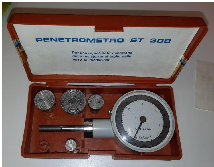
Figuur 1.1 Pocket penetrometer, in veld is opzetstuk met voetdiameter van 10 mm gebruikt.
