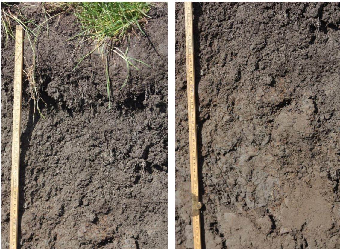
Figuur 2.4 Detailopnames van profielkuil 1. Links: de zodelaag tot circa 0.10 m -mv. Daaronder de laag met een fijne losse structuur die tot circa 0.35/0.40 m -mv doorloopt. Rechts: de overgang van de zone met een losse fijne structuur naar een open tot dichte grove structuur. De overgang begint hier rond 0.35 m -mv.
