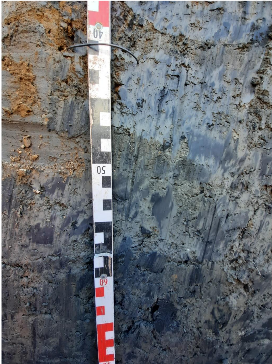
Figuur 3.7 Detailopname van profielkuil segment 3. Zowel de ijzeroxidevlekken (linksboven) als de zwarte FeS-vlekken zijn goed zichtbaar.
