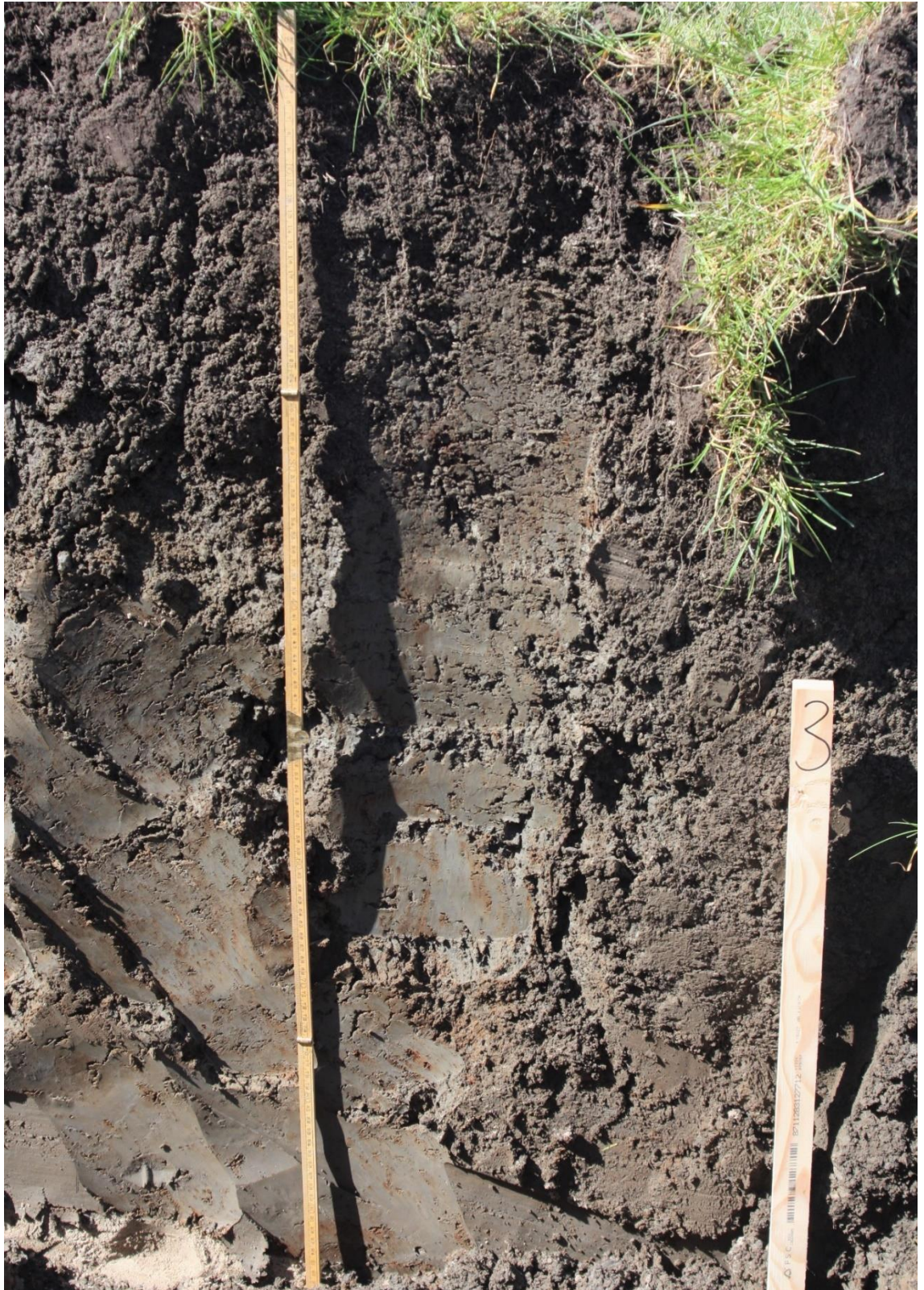
Figuur 2.6 Profielkuil 3. De duimstok is 1 m lang. De zodelaag boven is goed zichtbaar, met daaronder de fijne losse structuur tot circa 0.25 m -mv. Daaronder wordt de structuur grover en steeds dichter. Het dijkzand is zichtbaar links onderin.
