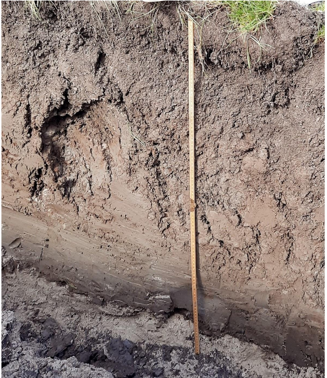
Figuur 2.3 Profielkuil 1. De duimstok is 1 m lang. De zodelaag boven is goed zichtbaar, met daaronder de fijne losse structuur tot circa 0.35/0.40 m -mv. Daaronder wordt de structuur grover en steeds dichter. Direct boven het dijkzand is de klei vrijwel massief.
