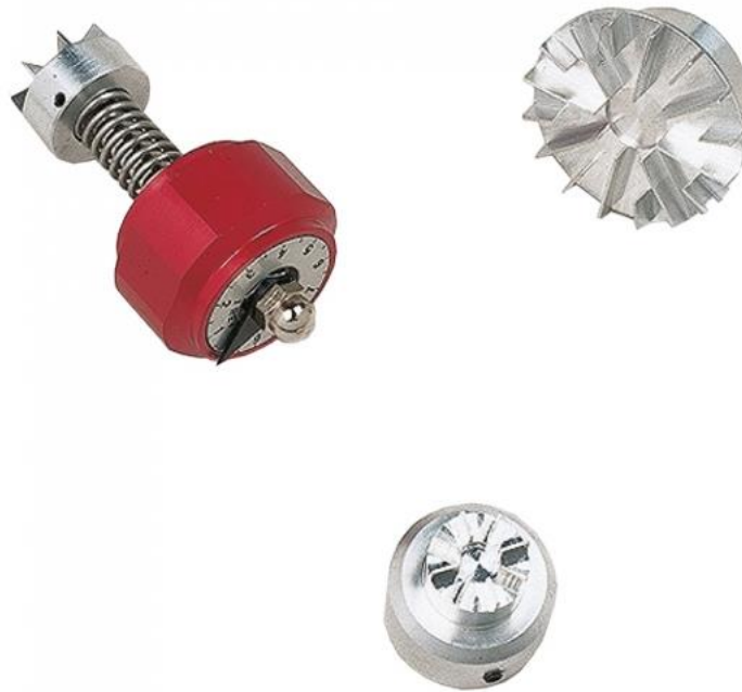
Figuur 1.2 Hand torvane, in veld is CL-100 gebruikt, hier zit deze vast aan het handvat.
