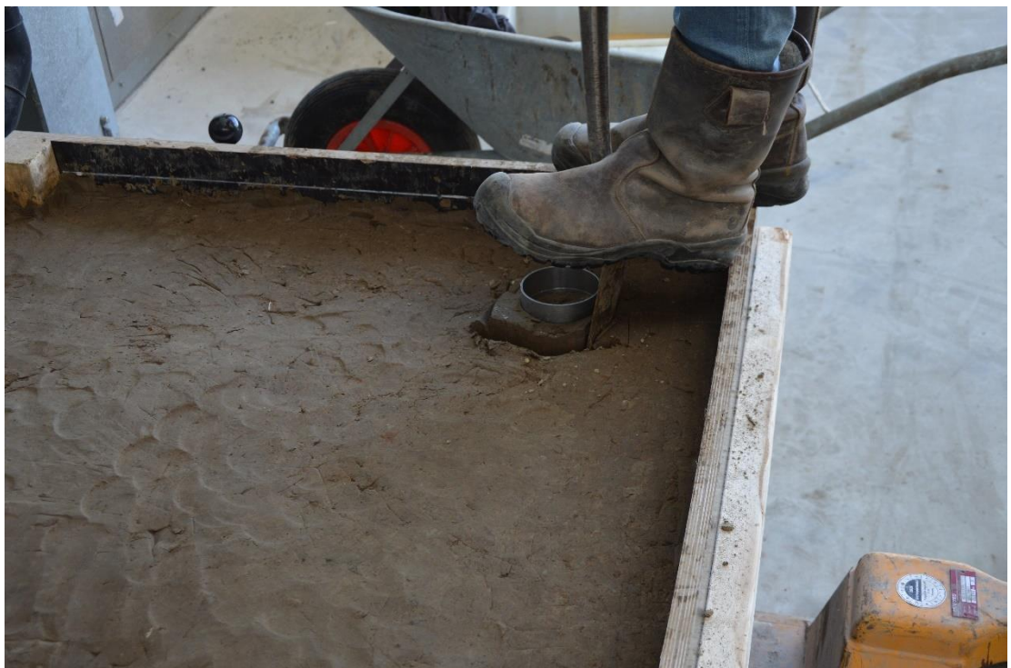
Figuur B.2 Steekringmonster na het aanbrengen van de klei in de bak.
