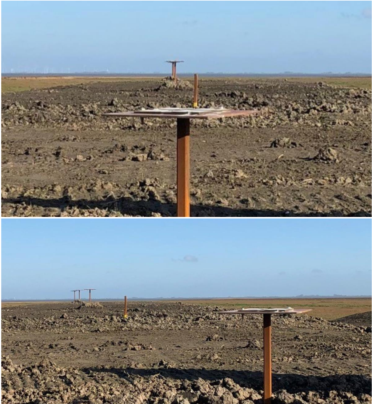
Figuur 11 - Zakbaken 3, 4 en 5 liggen op 1 lijn. Zakbaken 2 is afgebroken. Zakbaken 1 is verzakt
