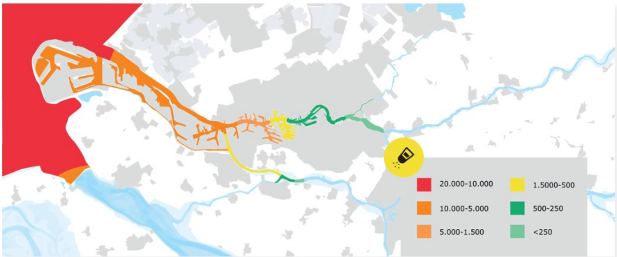
Figuur 8. Het zoutgehalte in de Rijn-Maasmonding bij gemiddeld getij en relatief hoge afvoer (5000-6000m 3 /s; boven) en lage afvoer (1100-1200 m 3 /s; onder) van de Rijn bij Lobith (Middelkoop et al., 2003).
