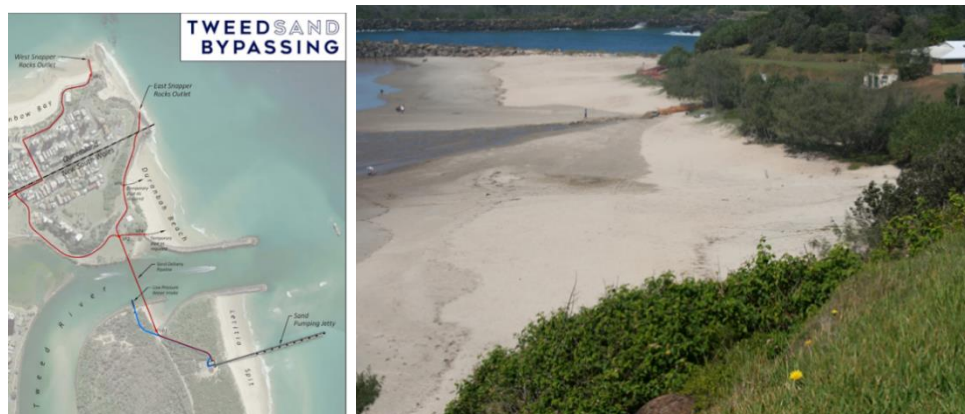
Figuur 12 Weergave van de Tweed River sediment bypass in Australië, met de layout van het persleidingssysteem (links) en de voedingslocatie op het strand (rechts). Bron: https://www.tweedsandbypass.nsw.gov.au/
