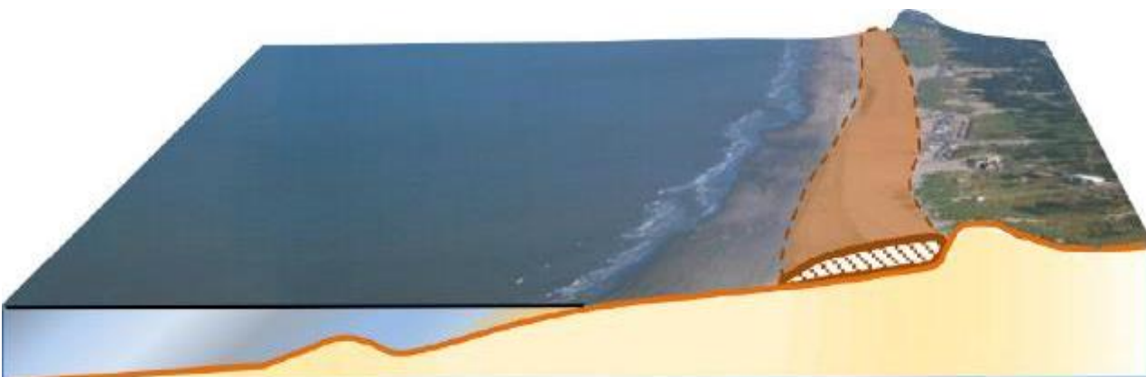
Figuur 6 Grafische weergave van strandsuppleties waarbij het zandpakket tegen de duinvoet aan wordt gesuppleerd. Bron: (Stive et al., 2013)
