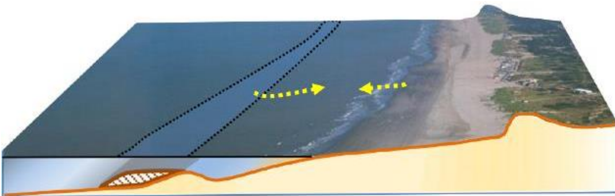
Figuur 5 Grafische weergave van vooroeversuppleties waarbij het zandpakket voor de kust op de vooroever wordt gesuppleerd. Bron: (Stive et al., 2013)
