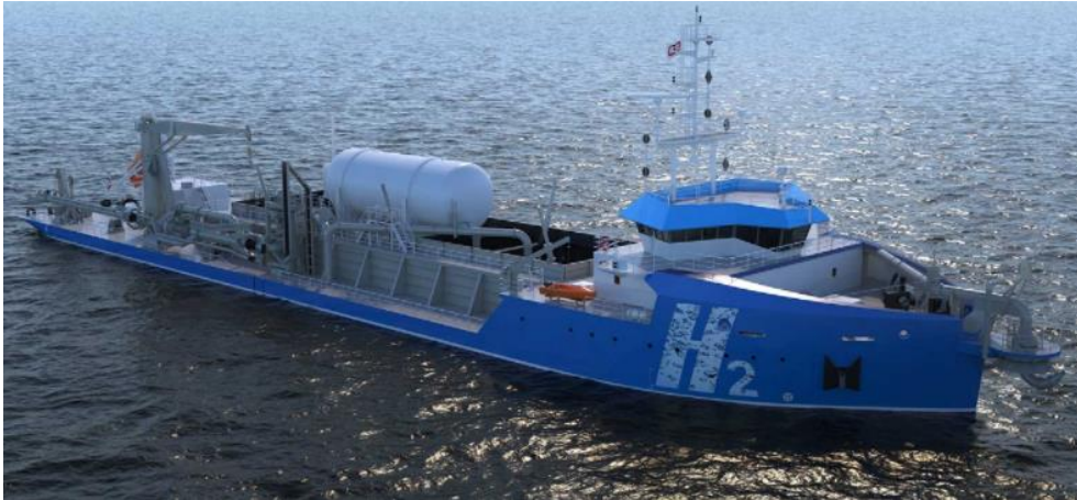
Figuur 9: Schematische weergave van een Leaf hopper, een door waterstof aangedreven sleephopperzuiger (IHC, 2021).
