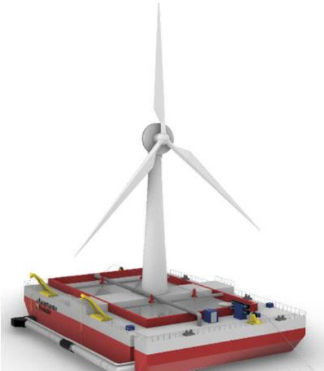
Figuur 12: Schematische weergave van de Cable Hopper inclusief de achterliggende ontwerpgedachte. Of er daadwerkelijk een windmolen op de Cable Hopper geplaatst kan worden moet nog worden onderzocht, in de voorliggende studie is uitgegaan van de aanvoer van duurzame elektriciteit via de kabel (Boskalis, 2021b).
