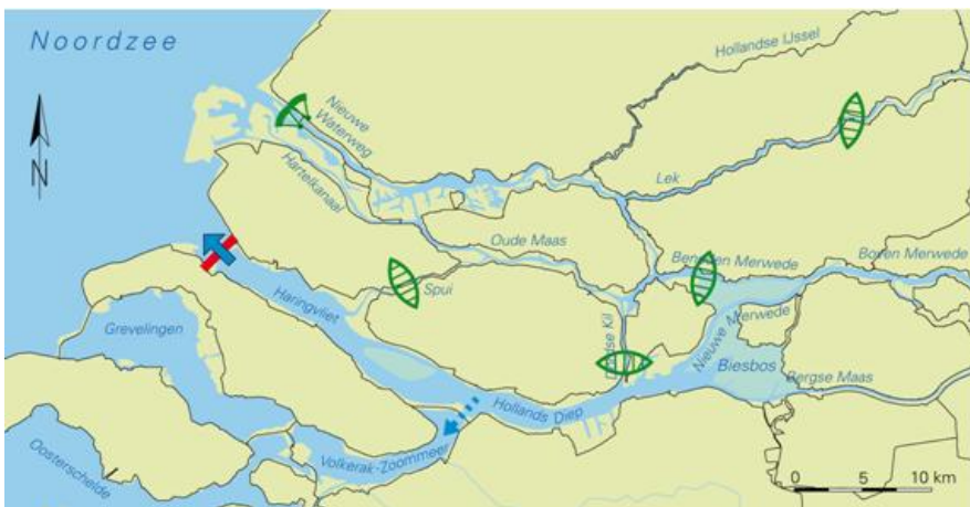
Figuur 5.6 Afsluitbaar – open: een stelsel van beweegbare stormvloed- en hoogwaterkeringen (variant 3)
