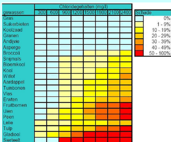
Figuur 6.15 Schadepercentages van verschillende gewassen voor beregenen met ‘brak’ water. Mondelinge mededeling Lodewijk Stuyt (Alterra), 2007.
