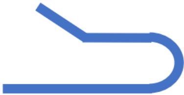
Figuur 6-4 Principetekening van kram
