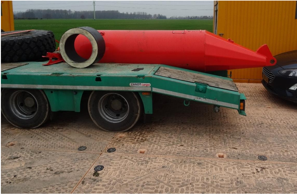
Figuur 2.8 Torpedo voor 24" leiding (foto: Deltares).
