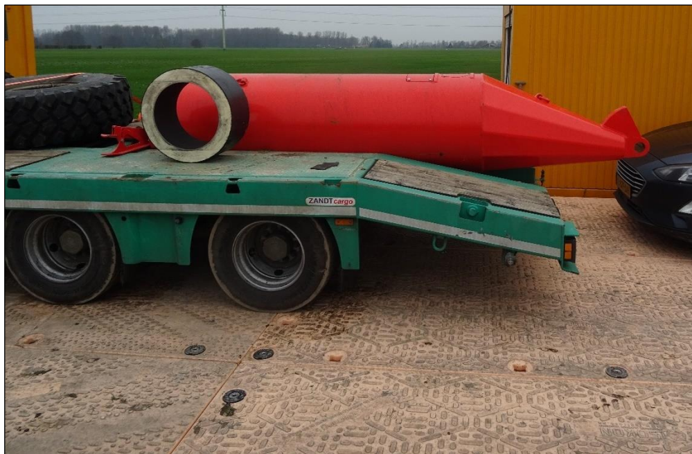
Figuur 3-8: 28" torpedo voor 24" leiding (bron: Deltares, Inploegen grote diameter Leidingen).
