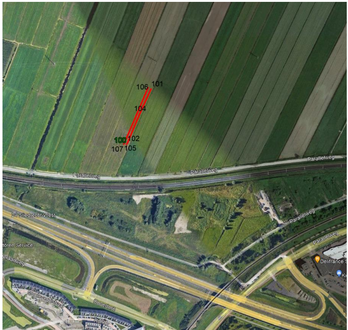
Figuur 3.5 Locatie Sliedrecht, tevens aangegeven de inploeglijnen van de testen in januari 2022 volgens data SpiderPlow; de test van april 2022 ligt ten westen (links op de foto) van de testen in januari 2022.
