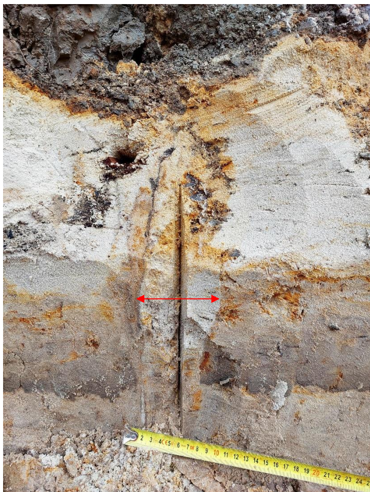
Figuur 6-17: Detail verstoring door zwaard profielkuil 4
