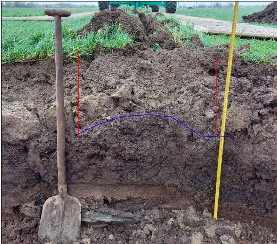
Figuur 5-4: Profielkuil – bodemprofiel tot 1,00 m -mv
