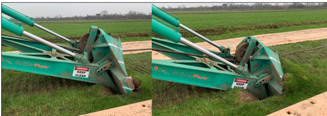
Figuur 3-4: Lier, met maximale indringing reactie schot (bron: Deltares, Inploegen grote diameter Leidingen)
