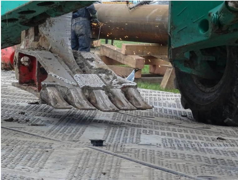
Figuur 2.5 Detail opname ripper shoe, tevens is onderste deel zwaard te zien (foto: Deltares).
