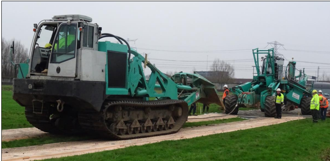
Figuur 3-2: Lier met ploeg (bron: Deltares, Inploegen grote diameter Leidingen)
