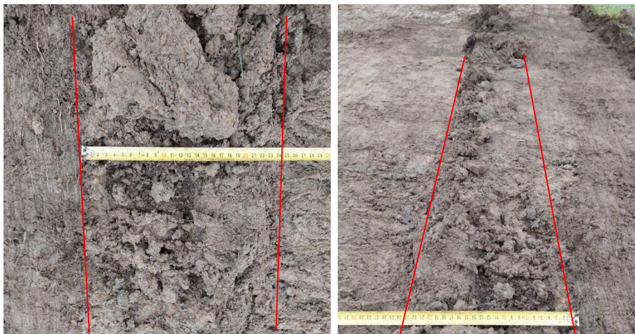
Figuur 7-8: Profielkuil 12" na afzetten humeuze bovengrond
