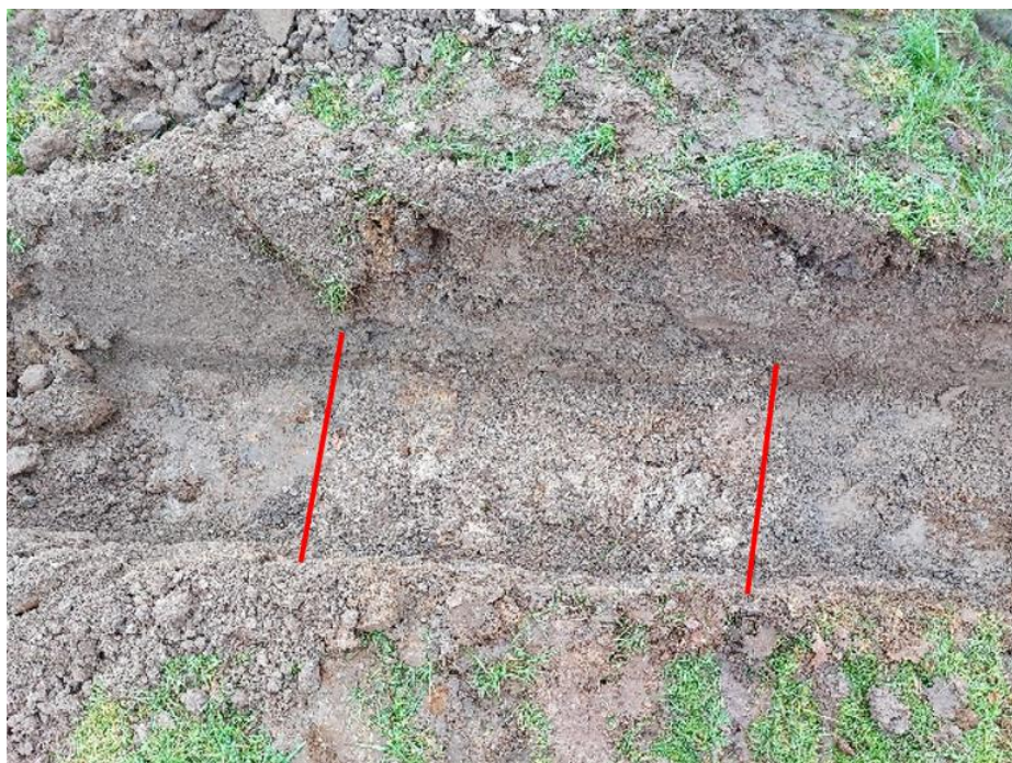
Figuur 6-11: Profielkuil 1 na afzetten humeuze bovengrond
