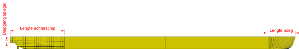
Figuur 3: Hoofdparameters lengte, breedte, diepgang en hoogte (ook wel holte genoemd)
