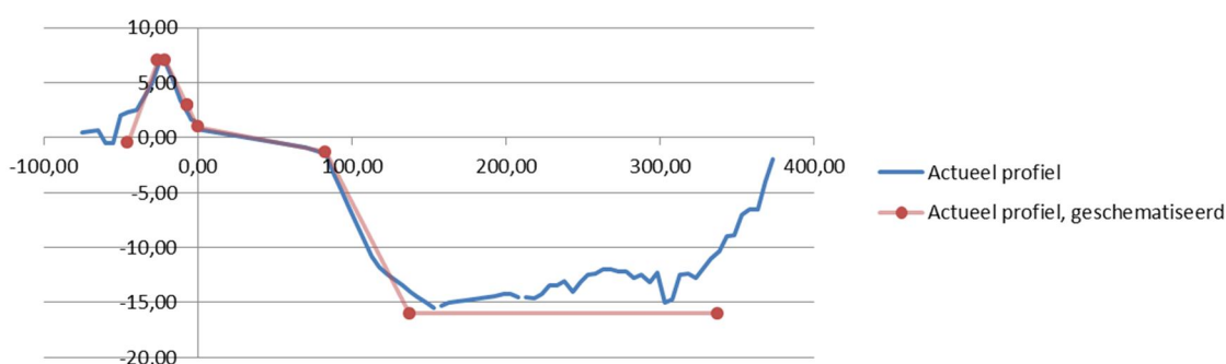
Figuur 8.3 Geschematiseerd profiel dijkvak 3
