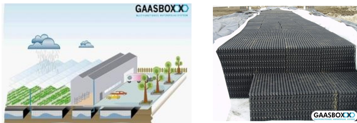
Figuur 1: Links: schema van de huidige toepassing van het Gaasboxx systeem; rechts: gekoppelde Gaasboxx elementen. Bron: www.gaasboxx.nl .
