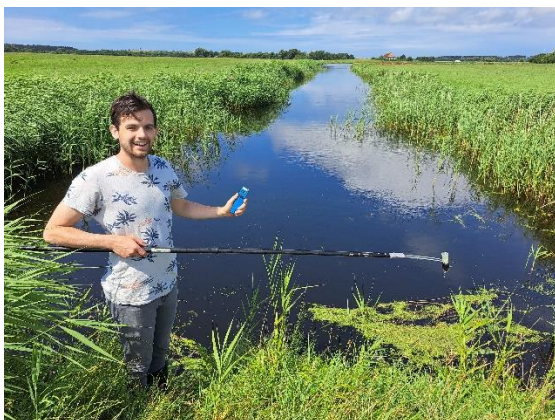
Foto 1: Een voorbeeld locatie van waar een EC meting in de sloot uitgevoerd kan worden. In de linkerhand een Hanna Dist4 EC meter en in de rechterhand een lange stok met daaraan een bakje om het water uit de sloot te scheppen.
