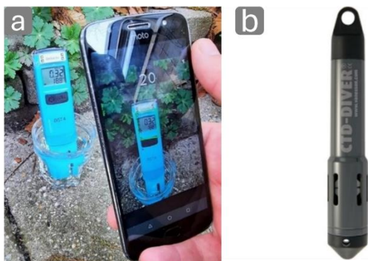
Figuur 4: a) Hanna Dist4 EC meter wordt gebruikt voor EC meting en maakt het mogelijk de meting makkelijk te delen via de Aquality App (Nitrate App/Deltares Aquality App | Deltares). b) Een CTD-Diver, ook EC meter, die wordt gebruikt voor het verrichten van slootmetingen over de hele lengte wanneer deze aan een vishengel wordt vastgemaakt (CTD-Diver - Water Services and Technologies).
