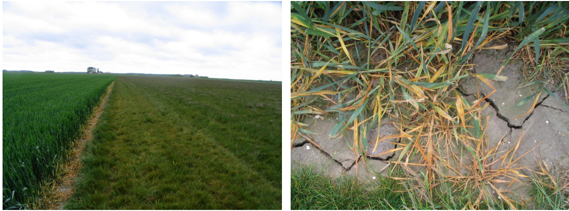
Figuur 2.2: Locatie 16. De doorlatenheidsmetingen zijn in het perceel met gras uitgevoerd (rechterkant van linker foto). Op de overgang van tussen de twee gewassen waren scheuren in de kleigrond zichtbaar (rechter foto).
