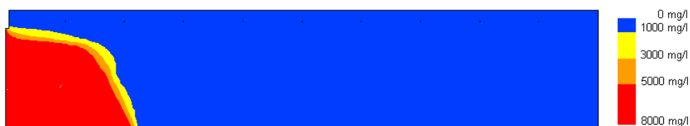
Figuur 3.26: Modelresultaten van aanpassing 16 (drukhoogte onderrand 9,00 m) met stationaire bovenrandvoorwaarden: chlorideverdeling in evenwichtssituatie.
