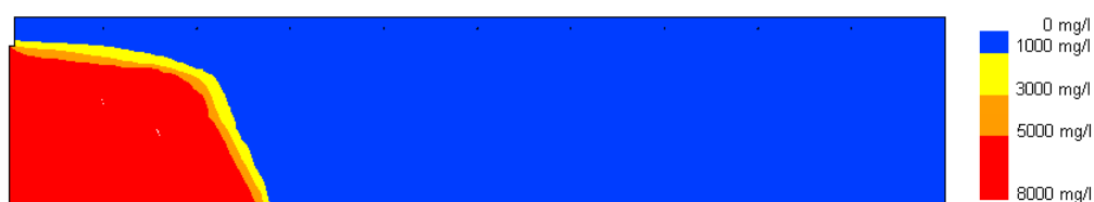
Figuur 3.24: Modelresultaten van aanpassing 1 (draindiepte 0,6 m -mv) met stationaire bovenrandvoorwaarden: chlorideverdeling in evenwichtssituatie.
