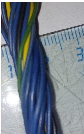
Figuur 2-6 24-ader kabel, diameter ca 10 mm.
