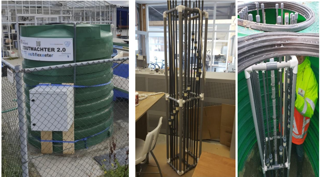
Figuur 2-2 Proefopstelling zoutwachter. Rechts en midden: frame met elektroden en minifilters (wit). Links: De ton is gevuld met zand en water. Van boven wordt er zoet water en van onder zout water geïnjecteerd.
